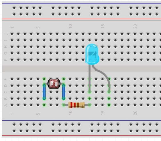
Stecke ein Kabel zwischen den Fotowiderstand und den **Minuspol** der Batterie:
